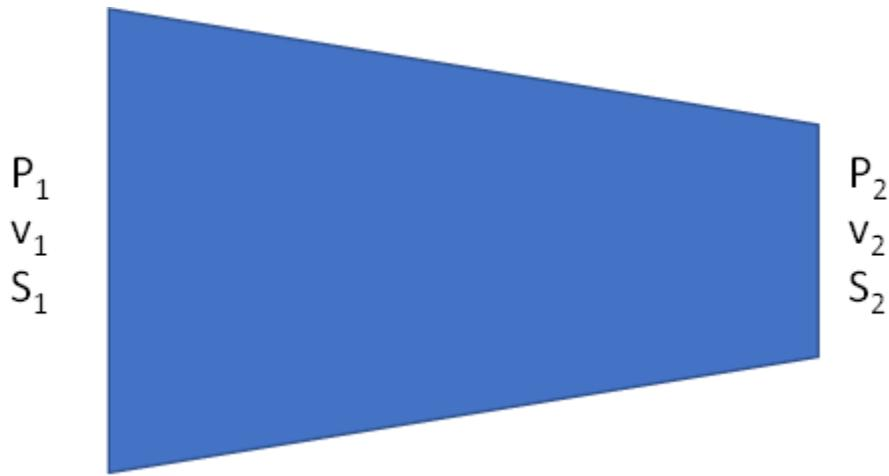
La sortie d'un tuyau d'arrosage présente une réduction de section.
