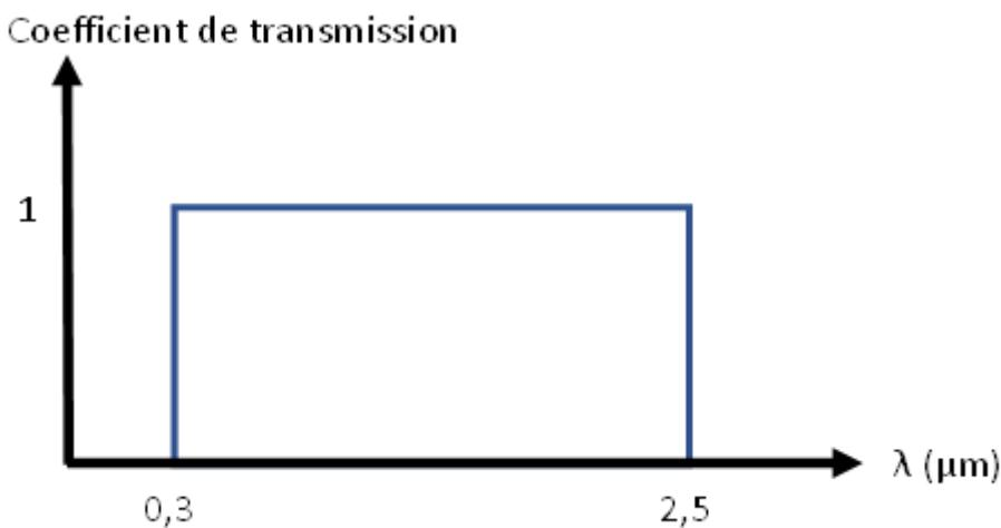
Il est transparent pour les longueurs d'onde comprise entre 0,3 et 2,5  $\mu\text{m}$  (il laisse passer la lumière) et absorbant ou réfléchissant en dehors de ce domaine.
